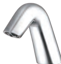
E-1061A $14,700 (110V~220V) 無鉛自動龍頭 （附無塞頭落水頭） 尺寸(mm)：H=135 H1=76 L=123 註：1.水壓範圍0.5~5kgf/cm 2 2.出水時LED燈顯示 3.感應器置於出水口 ※連續出水超過60秒自動停水 ※符合CNS8088國家標準(飲水龍頭)
