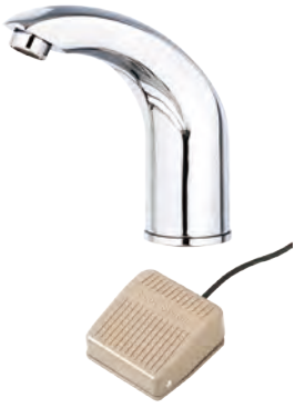
E-1025A $14,500 (110V~220V) 脚踏式龍頭 (附無塞頭落水頭) 尺寸(mm) : H=145 H1=120 L=110 註 : 水壓範圍0.5~5kgf/cm 2
