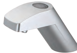
E-1038A $13,000 (110V~220V) E-1038DA $13,800 (3號鹼性電池) 電眼式自動龍頭 (附無塞頭落水頭) 尺寸(mm) : H=105 H1=60 L=135 註 : 1.水壓範圍0.5~5kgf/cm 2 2.出水時LED光圈LOGO顯示 3.上感應裝置 ; 龍頭主體為ABS材質 4.連續出水超過40秒自動停水 ※適用於溫泉區,可避免酸鹼度侵蝕
